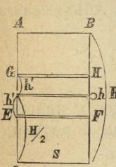
Разобъемъ весь столбъ на тонкіе горизонтальные слои равной толщины, такъ чтобы толщина каждого слоя была незначительна сравнительно съ высотой столба. Обозначимъ площадь основанія столба  $s$ , высоту —  $H$ , толщину каждого слоя —  $h$ , плотность жидкости  $d$ . Вѣсъ каждого слоя равенъ  $dsh$ , вѣсъ всего столба  $dsH$ . Средній слой, лежащий на высотѣ  $\frac{H}{2}$ , опускаясь съ этой высоты, произведетъ работу  $dsh \frac{H}{2}$ .
